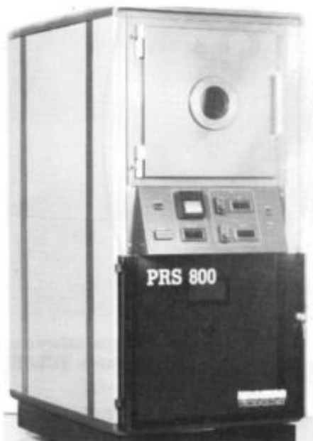
Afb. 7. Snelle fotoresist-stripper van Plasma Technology UK Ltd.
