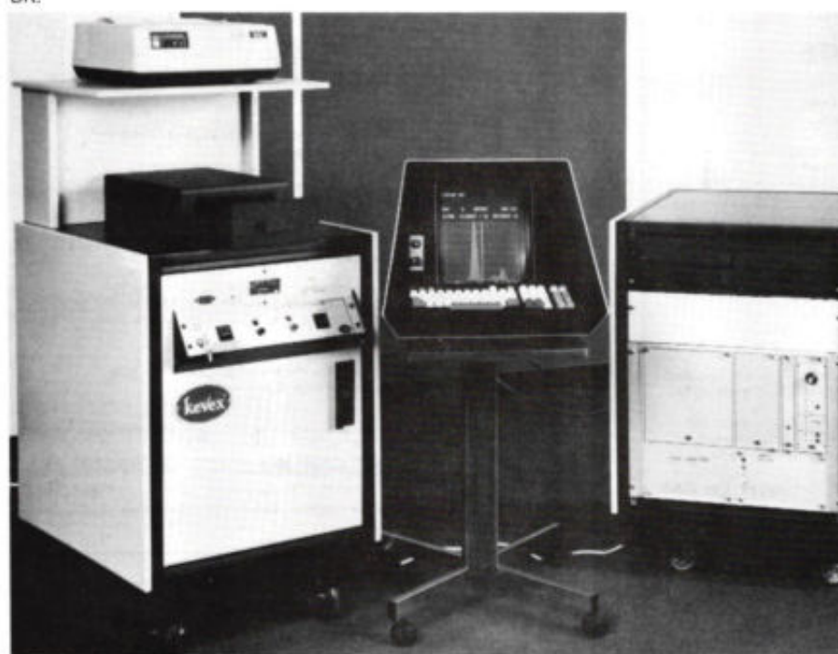
Afb. 3. Automatisch on-line analysesysteem voor dunne halfgeleiderfilms van Kevex Corporation UK.
