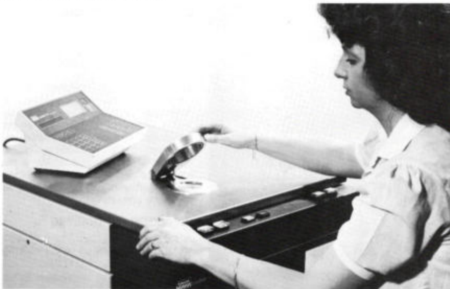
Afb. 5. Massaspectrometer Spectron 3000 voor snelle lekdetectie bij kleine ingekapselde componenten ( Edwards High Vacuum ).
